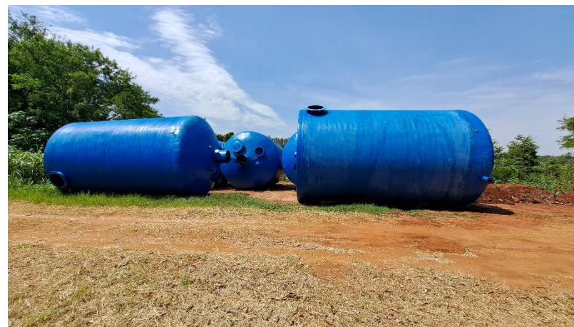
Foto 4 – Tanques de tratamento da ETE Modular Compacta.
