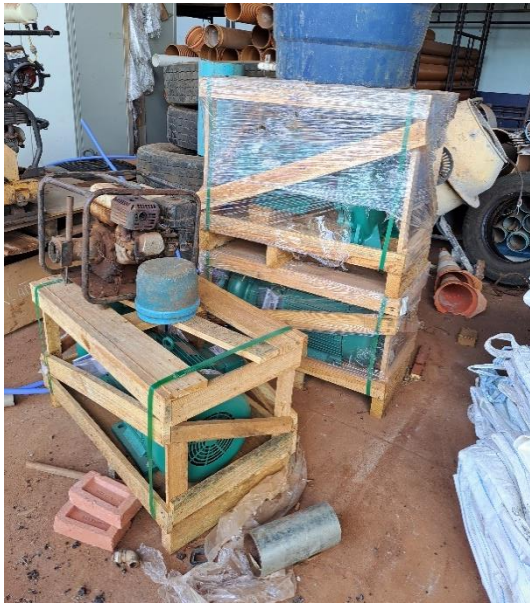
Três novos conjuntos motobombas adquiridos para a EEAT Campos Elísios II e Santa Cecília
